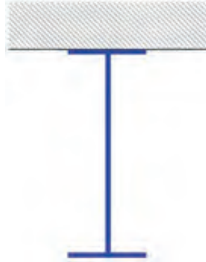
SEZIONE DI UN PROFILATO IN ALLUMINIO
