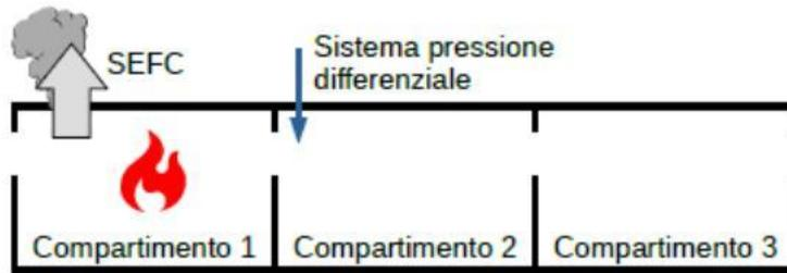
Il compartimento 2 è a *prova di fumo* proveniente dai compartimenti 1 e 3.
