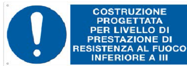
Illustrazione S.9-1: Esempio di segnale per livello di prestazione di resistenza al fuoco inferiore a III
